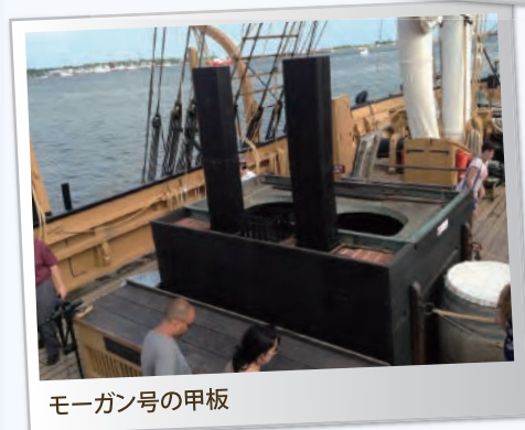
鯨の脂肪を熱して油をとる製油装置
